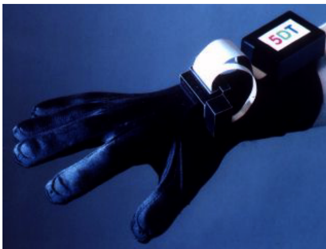
Figur 4-4. Sensorhandsken mäter böjningen av varje finger samt lutning och vridning av handen.
