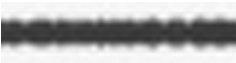
Figur 2. Det optiska ljudspåret i uppförstoring. Varianserna som här kan avläsas i den obrutna sekvensen är analog information.
